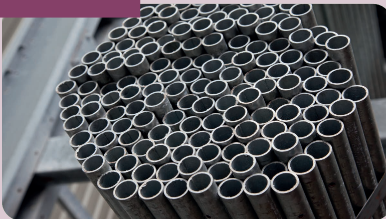
Protection anti-corrosion de tubes en bottes, par immersion.
